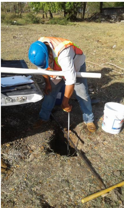
Medición de descenso de la columna de agua posterior a la saturación del medio.
