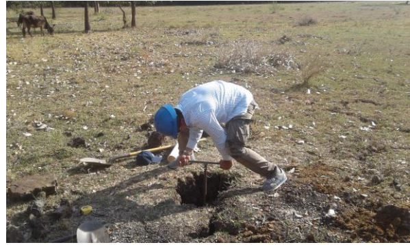
Sondeo manual con barreno para prueba de infiltración.
