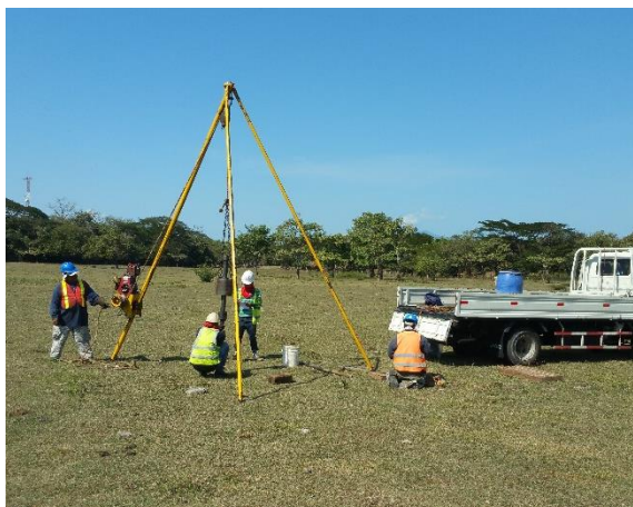
Foto No.5: Realización de Sondeo S.P.T No.3
