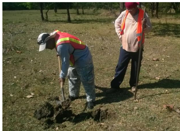
Foto No.1: Realización de Sondeo Manual No. 1
