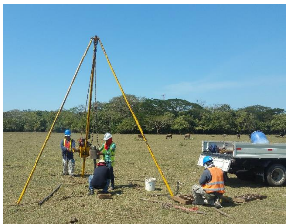
Foto No.1: Realización de Sondeo S.P.T No.1
