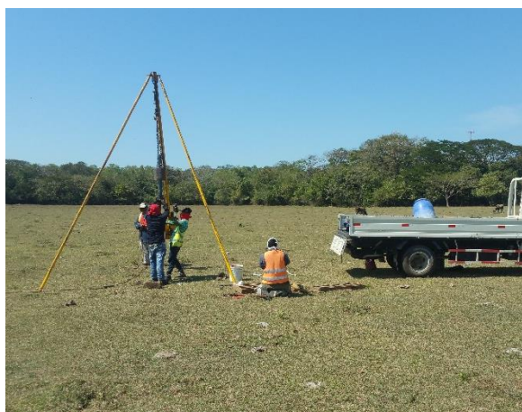
Foto No.3: Realización de Sondeo S.P.T No.2
