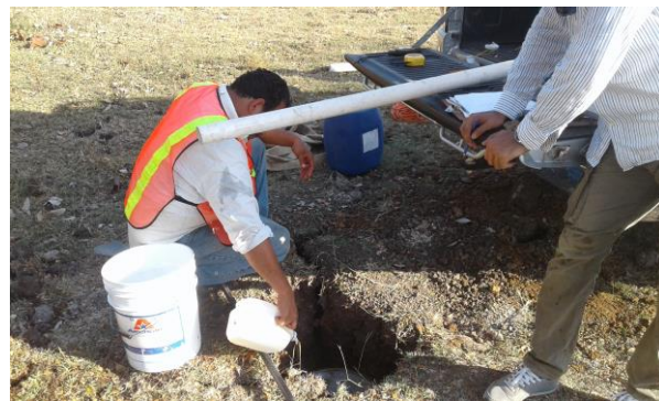
Medición de descenso de la columna de agua posterior a la saturación del medio.
