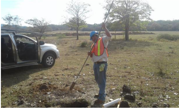
Sondeo manual con barreno para prueba de infiltración.
