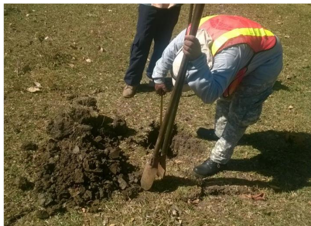
Foto No.2: Realización de Sondeo Manual No. 1
